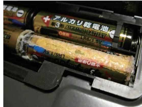
乾電池から液が漏れてベトベト。容器内のバネも錆びてしまっていて折れる寸前。
